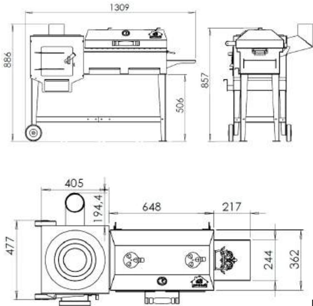
Рис.1 Габаритные размеры
