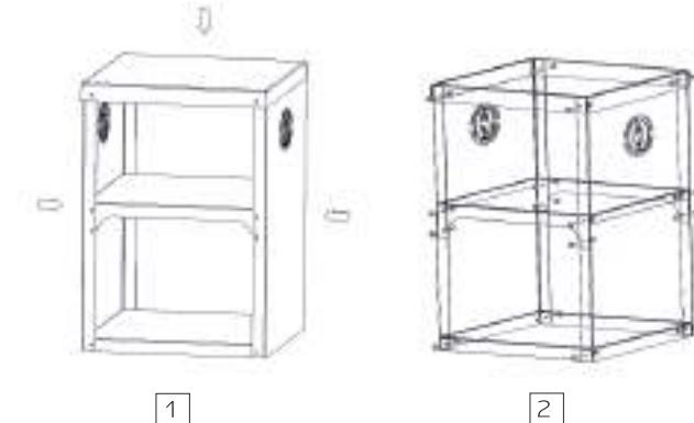
**Рис.3. Схема сборки подставки**
