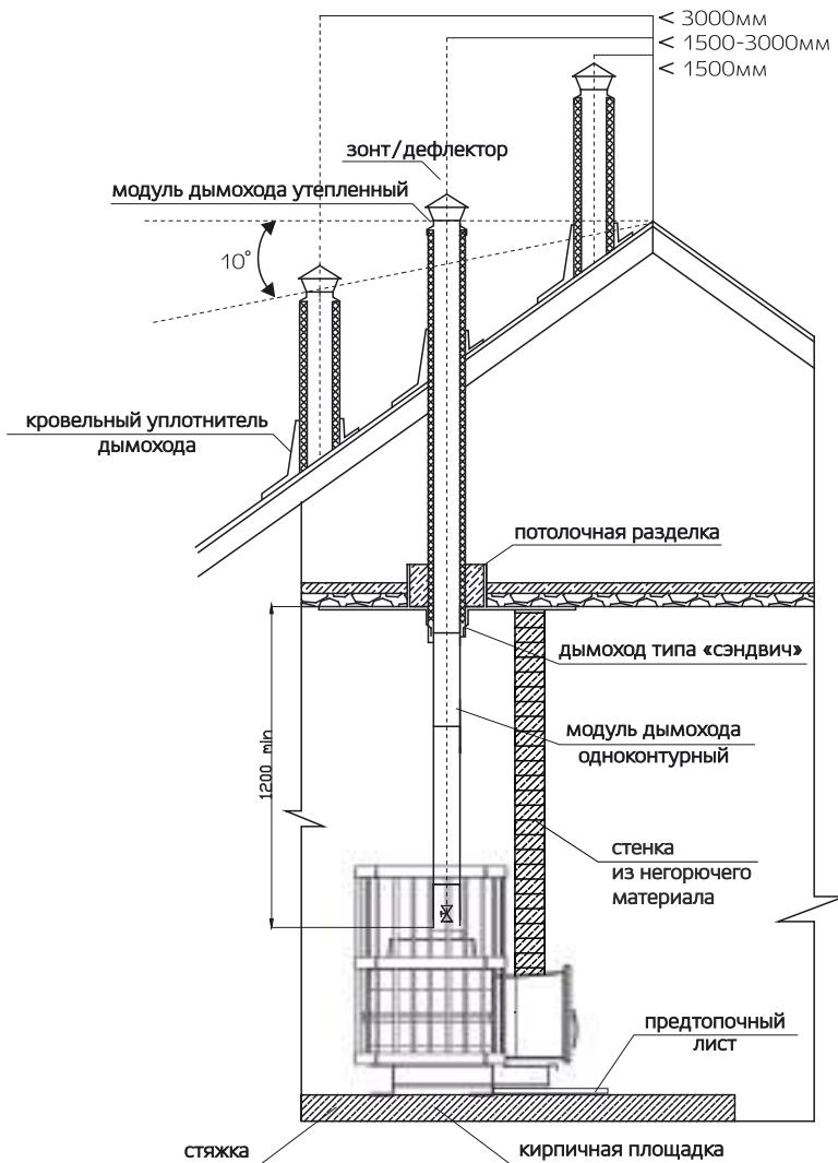
Рис. 3. Схема установки печи «Сибирь», вид сбоку
