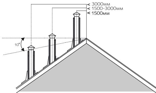
1. Не менее 500 мм над коньком кровли или парапетом, при расположении трубы на расстоянии до 1,5м от конька или парапета.
