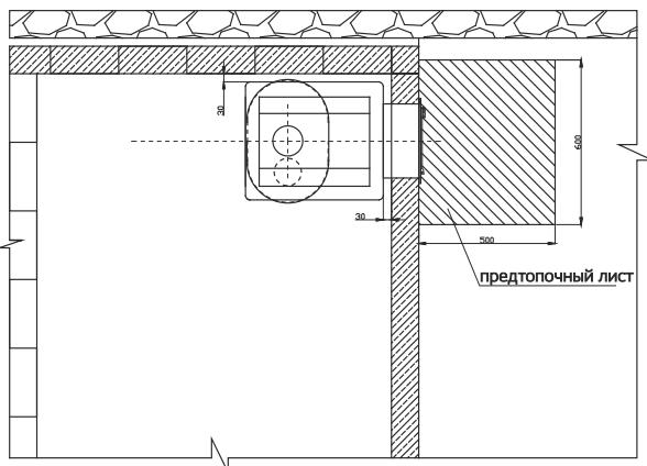
Рис. 4. Схема установки печи «Сибирь», вид сверху
