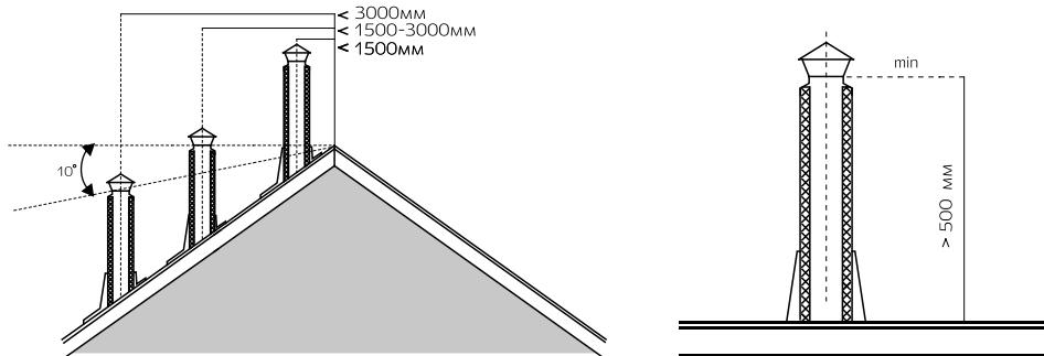
1. Не менее 500 мм над коньком кровли или парапетом, при расположении трубы на расстоянии до 1,5м от конька или парапета.
