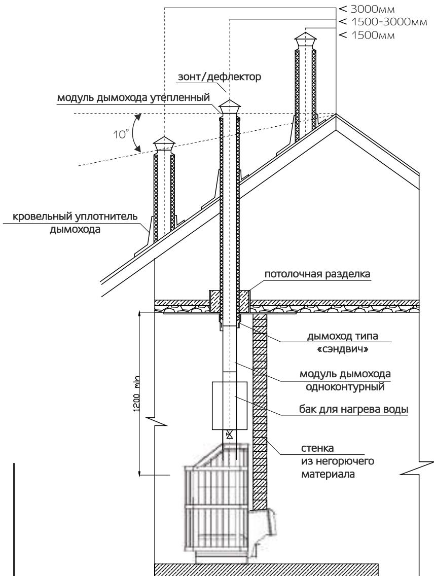
Рис. 3. Схема установки печи «Сибирь», вид сбоку
