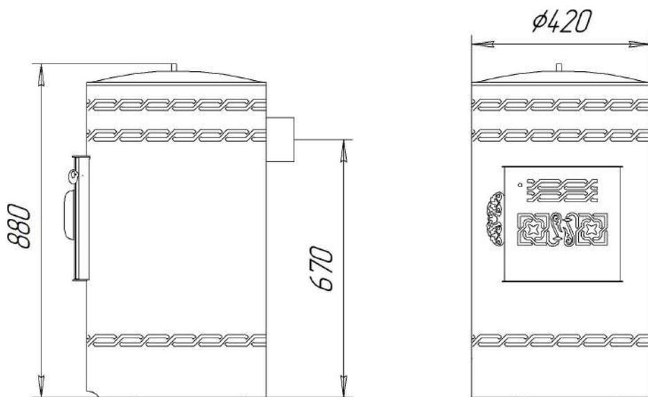
Рисунок 4. Общий вид печи с нанесенными основными размерами
