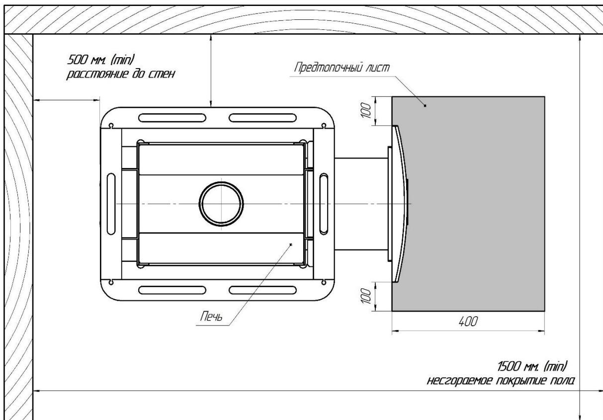
Рисунок 1: Вид сверху. Безопасные расстояния от стен при установке банной печи («ПИРАМИДА», «ПИРАМИДА Порта», «ПИРАМИДА Скала Порта»).
