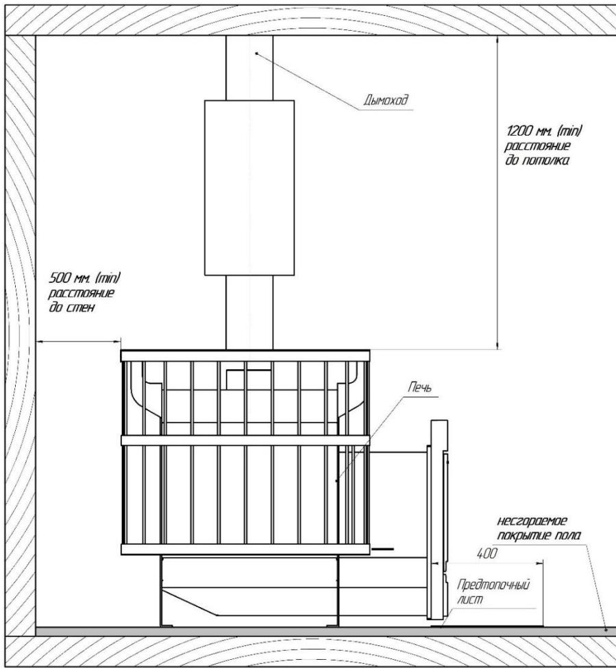
Рисунок 2: Вид сбоку: Безопасные расстояния от стен при установке банной печи («ПИРАМИДА», «ПИРАМИДА Порта», «ПИРАМИДА Скала Порта»).
