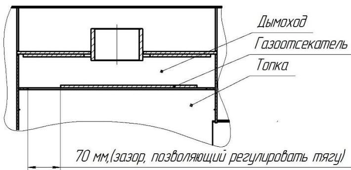
Центральный выход дымохода дает возможность установки бака любых форм, а также делает эксплуатацию печи более пожаробезопасной.
